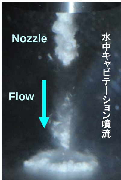
図7 キャビテーション噴流の概要ならびに様子
